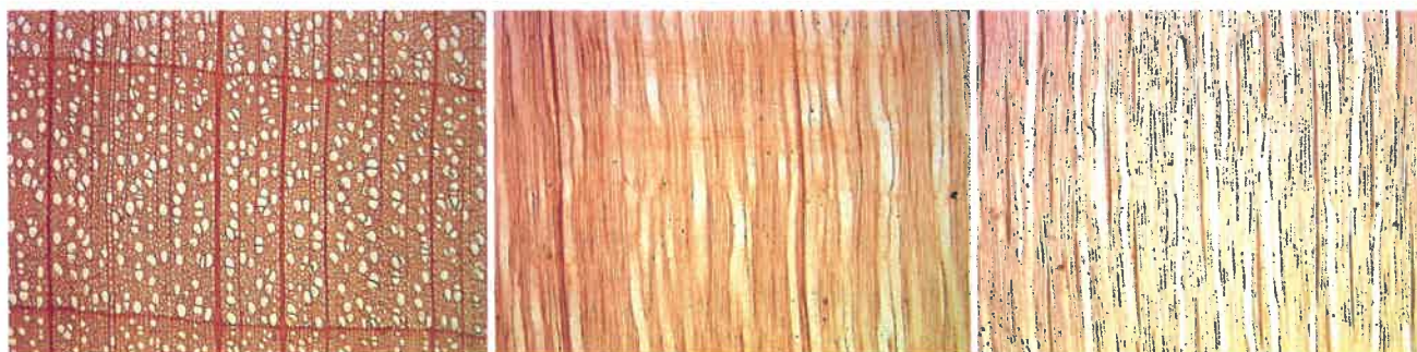
Obr. 3: Ukázka mikroskopické stavby dřeva lípy (Tilia sp.) – příčný, radiální a tangenciální řez
