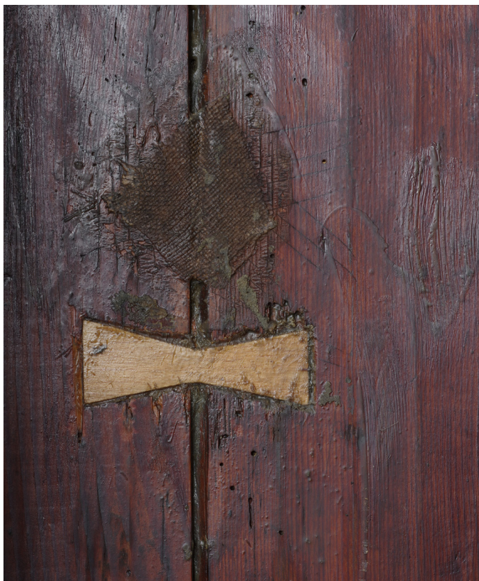
Stav před restaurováním, detaily pojištění spojů jednotlivých desek klaistrem přilepenými proužky plátna a dubovými motýlky, rozptýlené osvětlení 5600°K
